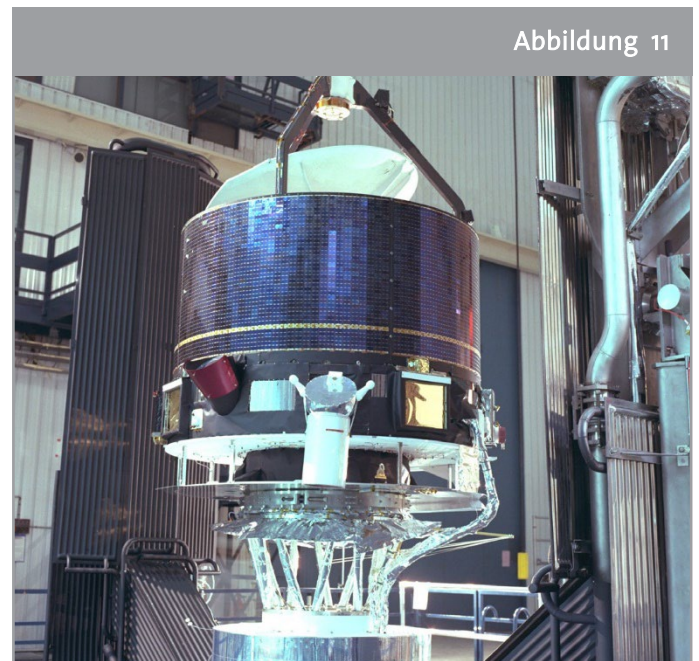
↑ Giotto bereit für den solaren Simulationstest. © ESA
