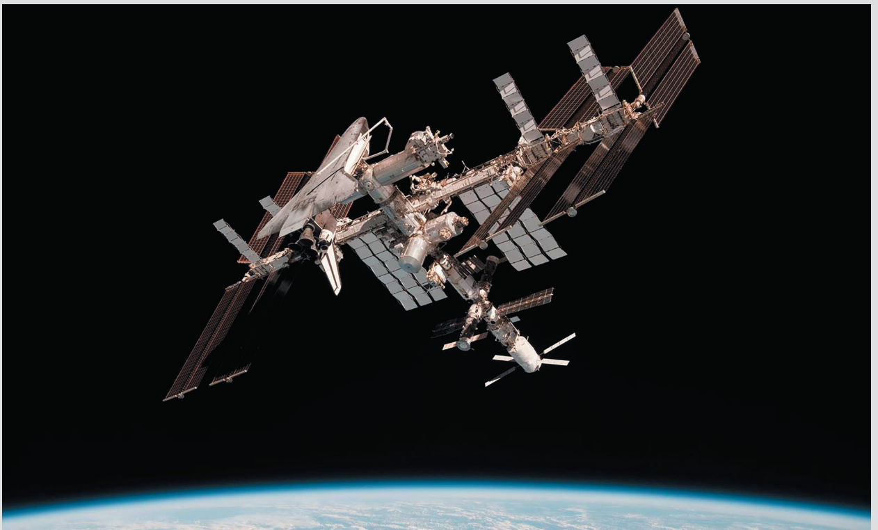
Vehículo Automático de Transporte acoplado a la Estación Espacial Internacional.
